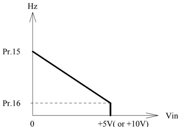
本模式類似 Pr.40 = 20，但 AI2 端子之信號變為 AI1 端子之信號變。在這個模式，AI1 端子之電壓信號將會用來決定變頻器運轉時候的輸出頻率。至於運轉方向的控制則由 Pr.39 來決定。
