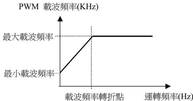
當運轉頻率大於載波頻率轉折點時，載波頻率變為最大載波頻率設定值，否則載波頻率依運轉頻率於最大載波頻率和最小載波頻率間自動調整。
