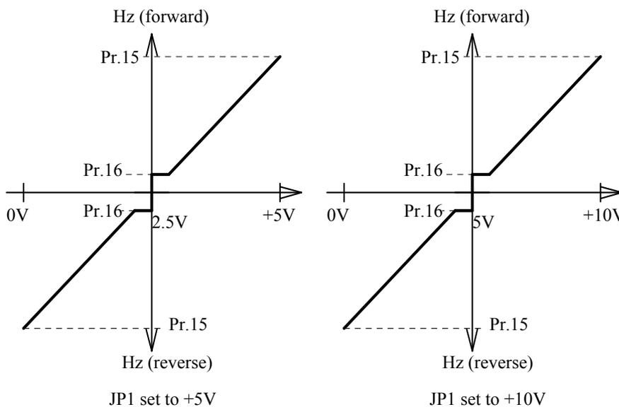
在這個模式，AI1 端子之電壓信號將會用來決定變頻器運轉時候的輸出頻率和運轉方向。輸入信號為最大值時，變頻器正轉於 Pr.15 所設定的頻率；輸入信號為零時，變頻器反向運轉於 Pr.15 所設定的頻率；當輸入信號約為中心點時，變頻器將運轉於 Pr.16 所設定的頻率。請比較 Pr.40=4 之功能。
