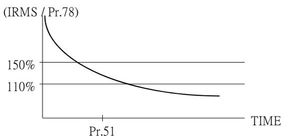
本變頻器內含電子式熱電驛。這個參數定義其過載跳脫時間。
