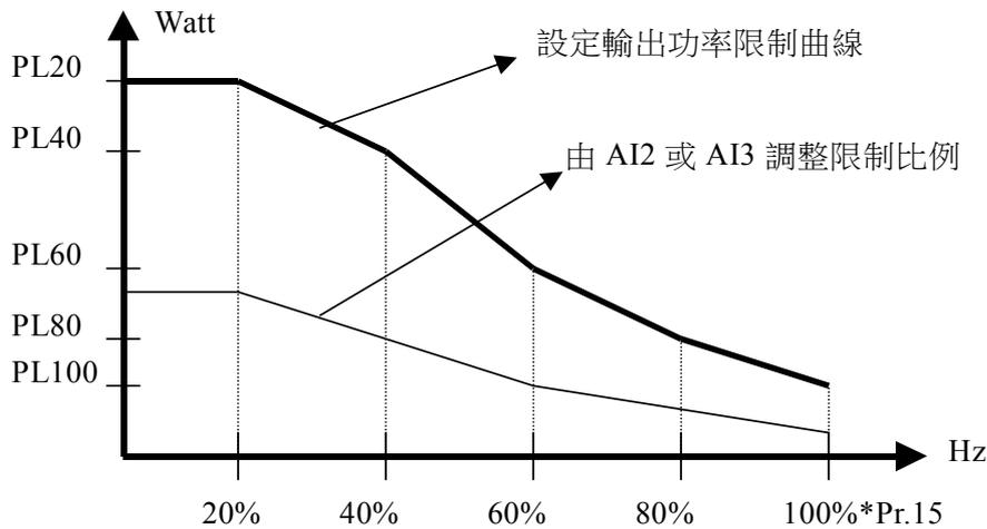
**Pr.67=4**：基本上運轉特性和 Pr.67=1 類似，當輸出功率超過設定的上限，變頻器將自動降低它的輸出的頻率。
