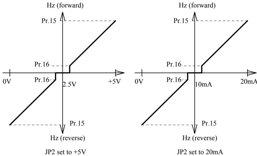
在這個模式，AI2 端子之電壓信號將會用來決定變頻器運轉時候的輸出頻率和運轉方向。輸入信號為最大值時，變頻器正轉於 Pr.15 所設定的頻率；輸入信號為零時，變頻器反向運轉於 Pr.15 所設定的頻率；當輸入信號約為中心點時，變頻器將停止輸出。請比較 Pr.40=10 之功能。
