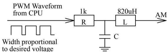
AM 端子的輸出電壓是來自中央處理器的 PWM 波形。輸出電壓的大小與 PWM 波形的寬度成正比。而且 PWM 信號先被內部的電阻 R 和電容器 C 過濾平滑。
