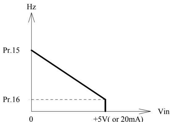
在這個模式，AI2 端子之電壓（或電流）信號將會用來決定變頻器運轉時候的輸出頻率。至於運轉方向的控制則由 Pr.39 來決定。
