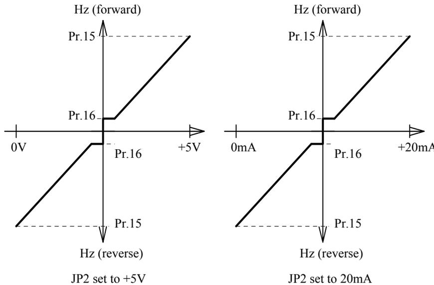
在這個模式，AI2 端子之電壓信號將會用來決定變頻器運轉時候的輸出頻率和運轉方向。輸入信號為最大值時，變頻器正轉於 Pr.15 所設定的頻率；輸入信號為零時，變頻器反向運轉於 Pr.15 所設定的頻率；當輸入信號約為中心點時，變頻器將運轉於 Pr.16 所設定的頻率。請比較 Pr.40=5 之功能。
