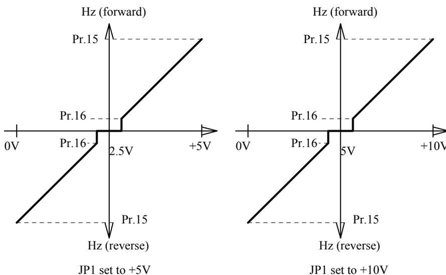
在這個模式，AI1 端子之電壓信號將會用來決定變頻器運轉時候的輸出頻率和運轉方向。輸入信號為最大值時，變頻器正轉於 Pr.15 所設定的頻率；輸入信號為零時，變頻器反向運轉於 Pr.15 所設定的頻率；當輸入信號約為中心點時，變頻器將停止輸出。請比較 Pr.40=9 之功能。
