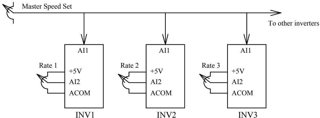
**7.2.13 Pr.40 = 13**，設定頻率 =  $A12 \pm (Pr.15 * (Pr.70 * AI1))$  (適合同步連動運轉)
