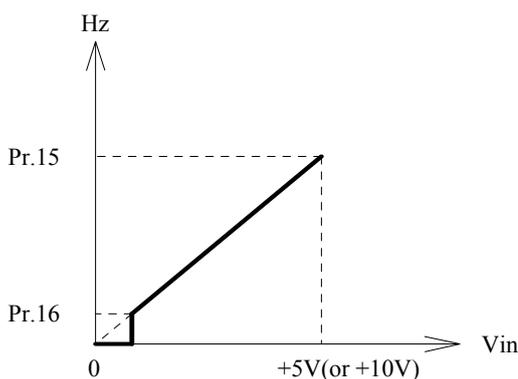
在這個模式，AI1 端子之電壓信號將會用來決定變頻器運轉時候的輸出頻率。至於運轉方向的控制則由 Pr.39 來決定。
